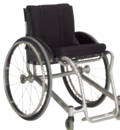
■ W5 fuldsvejset fastrammekørestol, vægt fra 6,0 kg. Fås også med justerbar bagaksel, fodstøtte samt folderyg.
